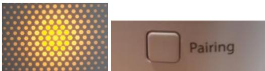
Nun beginnt die Box mit dem Verbindungsaufbau zur START-Box. Beide Boxen blinken nun in Grün für ca. 2 Min. Sobald die Box konstant blau leuchtet, ist sie verbunden
